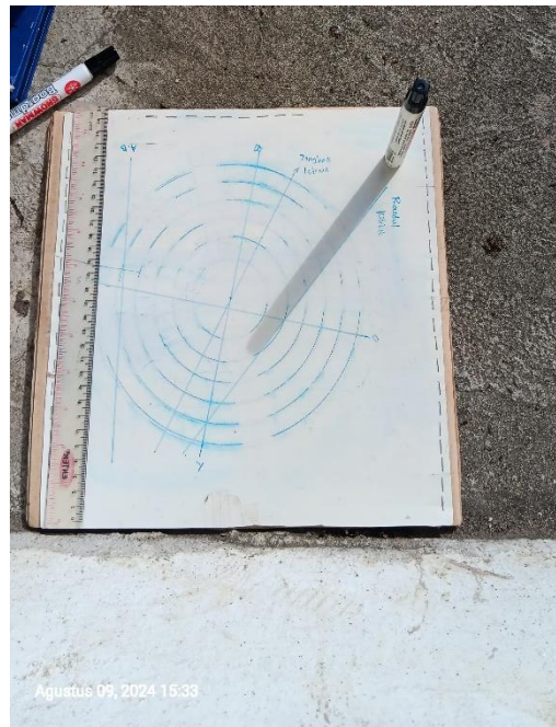
Gambar 4.14 Pengukuran Metode Tongkat Istiwa dan Rasdhul Qiblat Harian pada Masjid Baiturrahman Salue Galung Lombok
