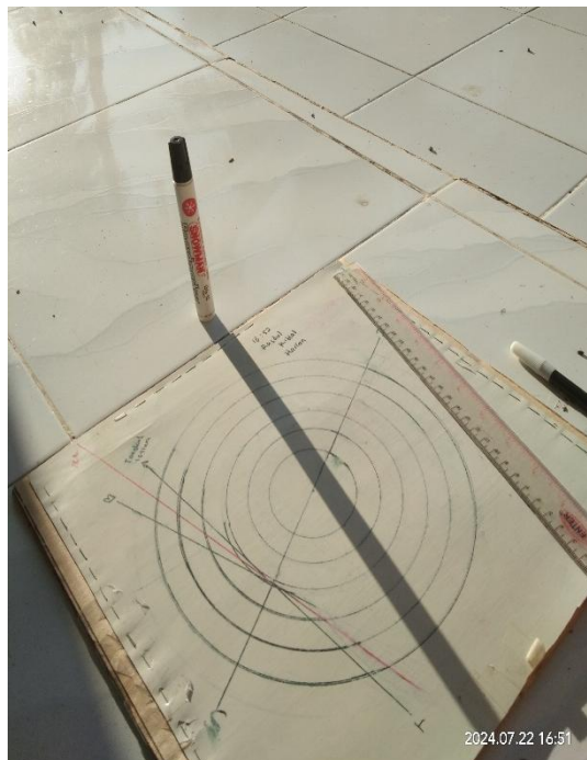
Gambar 4.16 Pengukuran Metode Tongkat Istiwa dan Rasdhul Qiblat Harian pada Masjid Taqwa Tangnga-Tangnga
