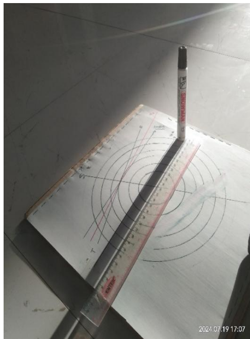
Gambar 4.3 Pengukuran Metode Tongkat Istiwa dan Rasdhul Qiblat Harian pada Masjid Besar Al-Hurriyyah Tinambung
