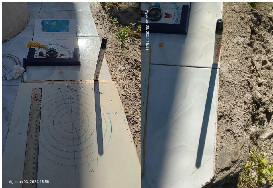
Gambar 4.13 Pengukuran Metode Tongkat Istiwa dan Rasdhol Qiblat Harian pada Masjid Nurut Taqwa Tandung
