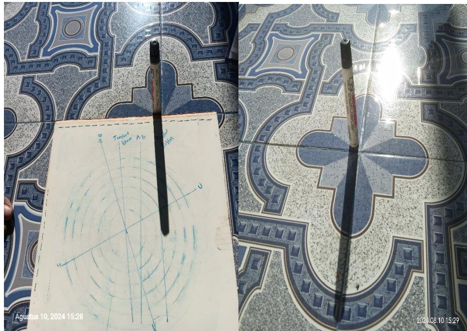
Gambar 4.12 Pengukuran Metode Tongkat Istiwa' dan Rasdhul Qiblah Harian pada Masjid Sepa'batu
