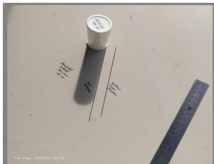
Gambar 4.7 Hasil Pengukuran Arah Kiblat Pada Masjid Ridha Desa Lego
